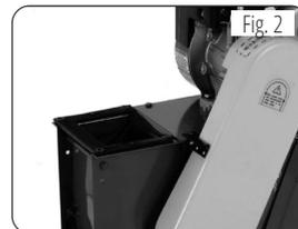
Positionnement du joint de la trémie
