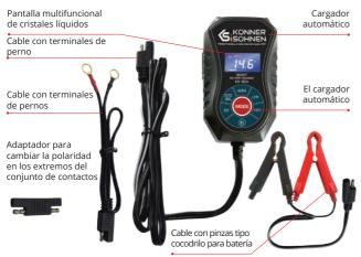
Este cargador automático está diseñado para utilizarse con una tensión nominal de 230 V. Tiene un conector SAE en el cable de carga, que le permite cambiar el tipo de terminal a un bullnose o terminal de anillo (suministrado), y con la boquilla especial suministrada con el dispositivo, puede cambiar la polaridad de los cables.
